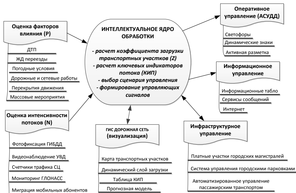
Рис. 1. Архитектура интеллектуальной системы управления дорожно-транспортным комплексом
