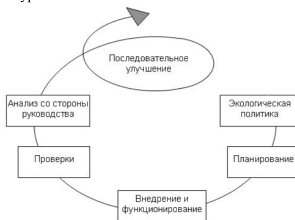
Рис. 1. Модель системы управления окружающей средой по стандарту ISO-14001:2004
