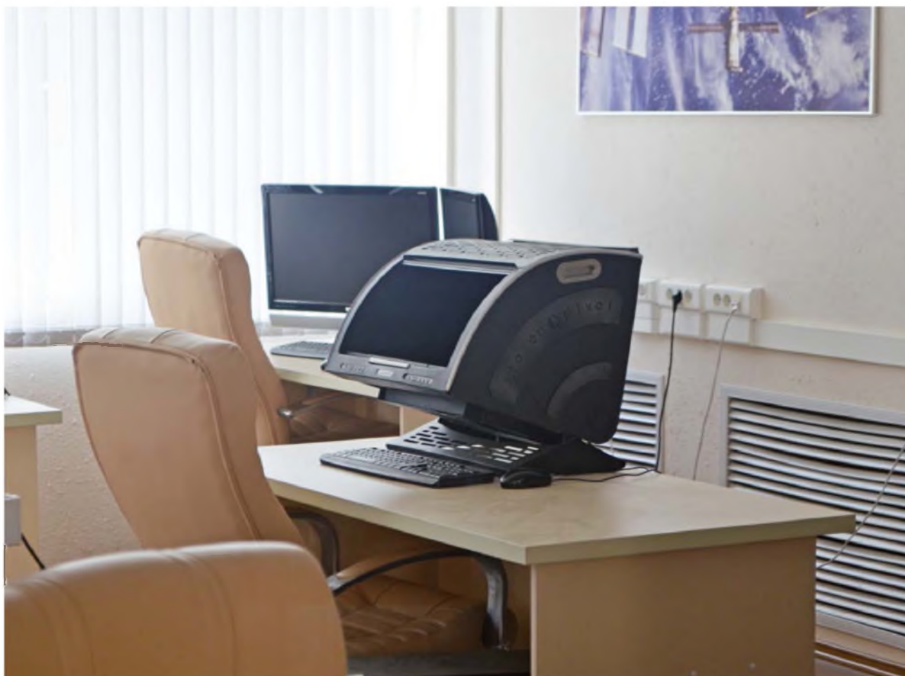
Стереостанция, предназначенная для формирования цифровых моделей рельефа местности
